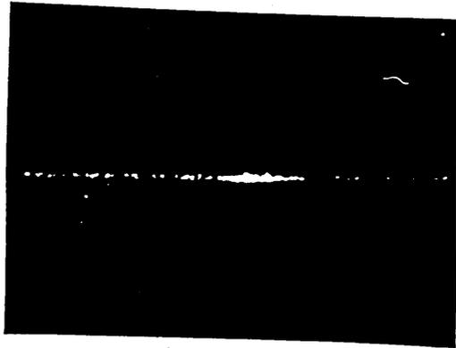
図 24 マッハ・ツェンダー形回路出力端からの出力パターン(波長=1.15 $\mu$ m)
