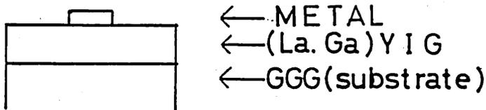
(4) Ar ION-BEAM ETCHING
